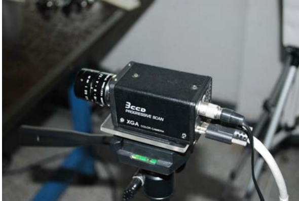
รูปที่ 6 กล้องซีซีดีที่ผู้วิจัยใช้ในการบันทึกภาพสนามความเค้นควบคู่กับโพลาไรสโคปมาตรฐานในรูปที่ 3ข
