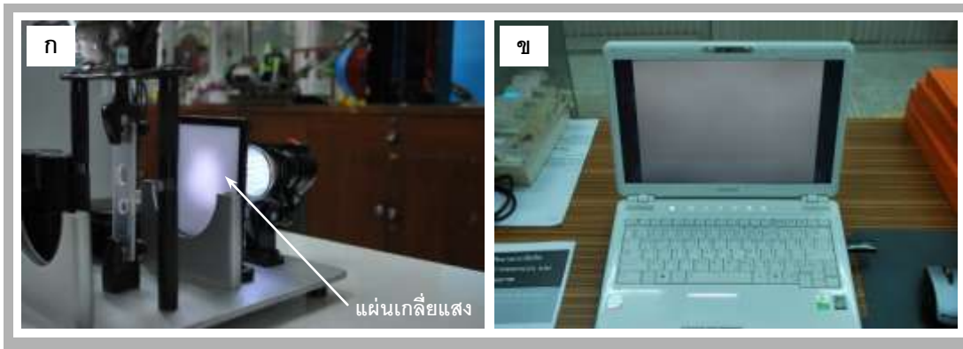
รูปที่ 3 แหล่งกำเนิดแสง (ก) ไดโอดเปล่งแสง (ข) จอภาพแบบแอลซีดี ของเครื่องคอมพิวเตอร์ ส่วนบุคคล
