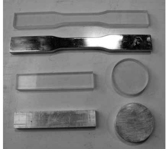
รูปที่ 5 ตัวอย่างที่ได้จากการตัดขึ้นรูปด้วยเครื่องตัดที่สร้างขึ้นใช้เองในห้องประลอง (ตัวอย่างคานสีเหลืองด้านซ้ายมือไม่ได้ถูกนำมาใช้ทดลองและนำเสนอในบทความฉบับนี้)
