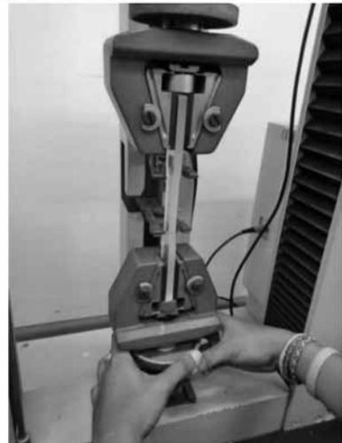
รูปที่ 7 เครื่องทดสอบแรงดึง (Universal Testing Machine) และการติดตั้งตัวแบบเรซินรูปทรงดัมเบลล์เข้ากับหัวจับในเครื่องทดสอบดึงเพื่อหาค่ายังสัมมอดูลัส E
