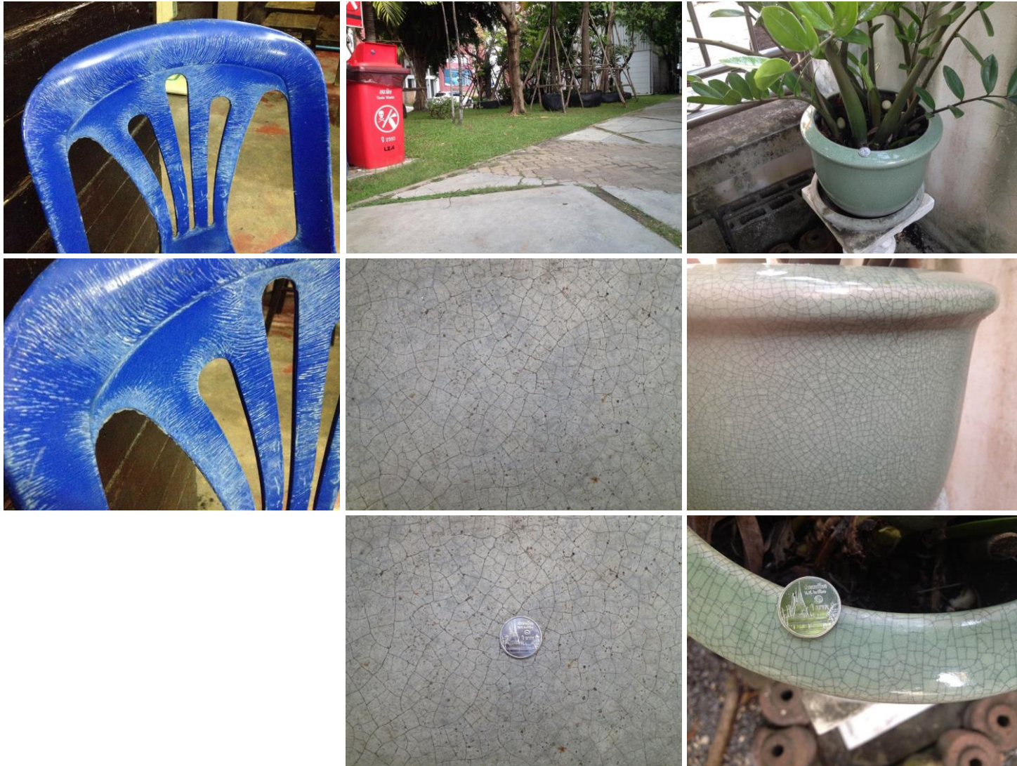
รูปที่ 4 รอยแตกร้าวตามธรรมชาติของผิวคอนกรีต ผิวเคลือบกระถางต้นไม้ และผิวของพรางตึกที่ใช้ทำเก้าอี้อื่นเนื่องจากการกระจายตัวของความเค้นทั่วทั้งผิว
