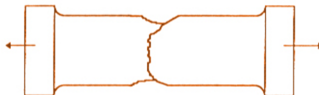
รูปที่ 5 การขาดแบบ cup & cone อิทธิพลของความเค้นระนาบและความเครียดระนาบ
